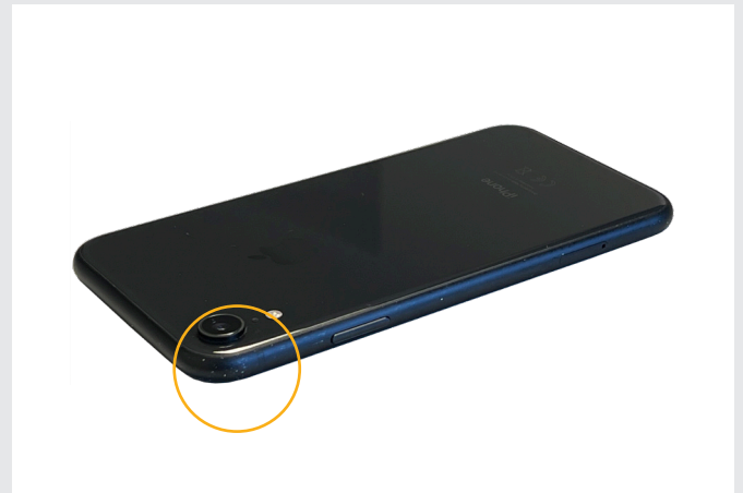
Mittlere Abnutzung/Verfärbungen an den Gehäuseecken.
