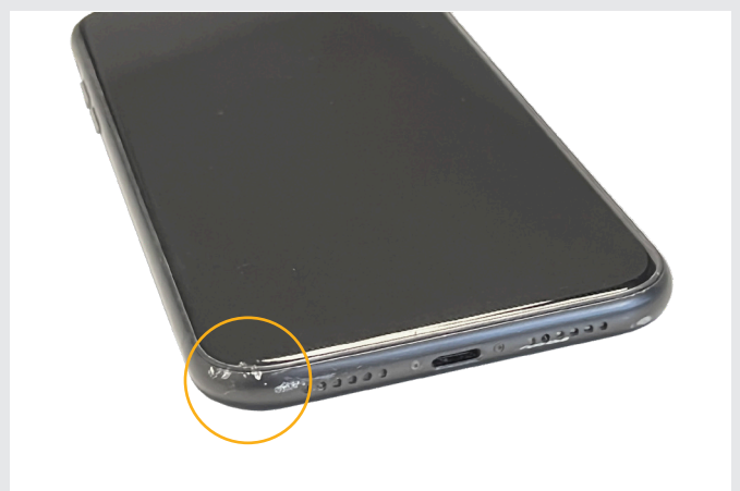
Starke Beulen/Einkerbungen an den Gehäuseecken.
